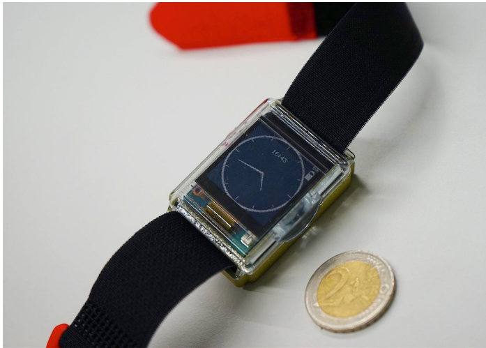
Moderne „Wearables“ können eine Vielzahl von Sensoren integrieren, die sich zur Anfallserkennung nutzen lassen (hier: Entwicklung des IMTEK Freiburg, Prof. van Laerhoven). © Universität Freiburg / van Laerhoven
