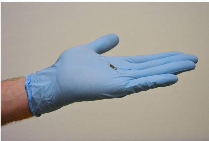
Das Implantat besteht aus einem etwa einen Zentimeter großen Sensor und zwei Antennen. © Universitätsklinikum Freiburg
