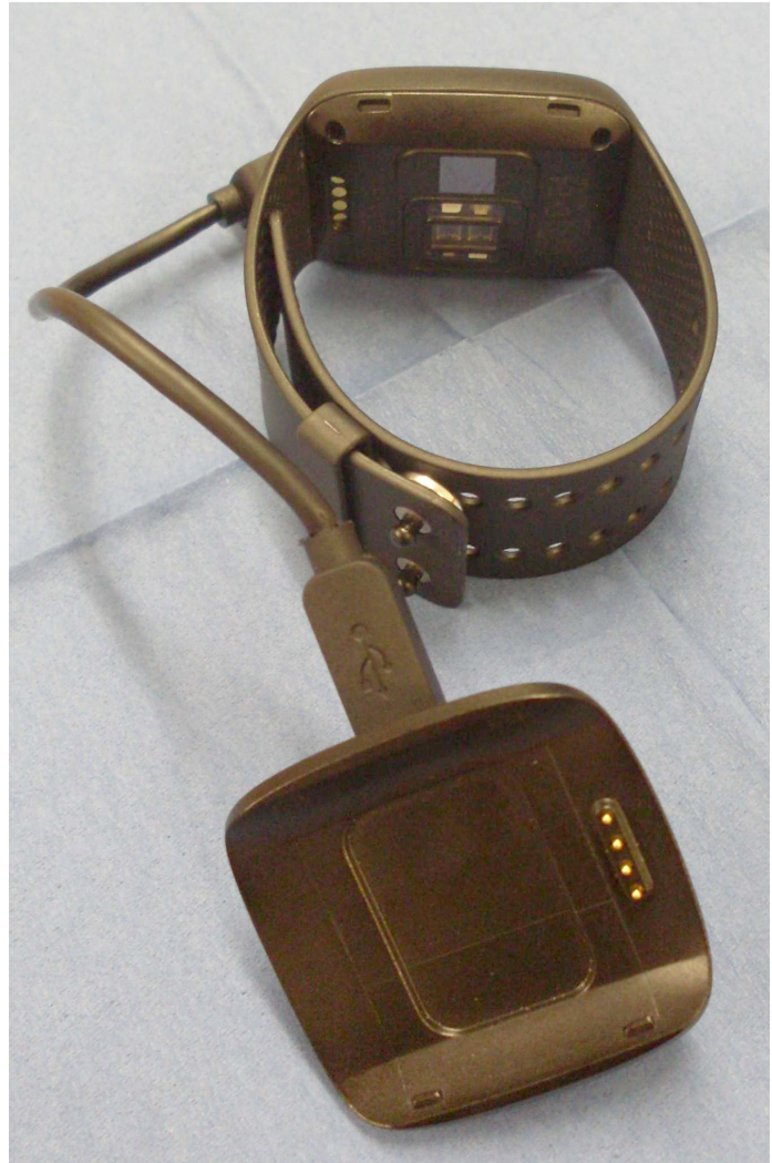
Der Studienteilnehmer trägt ein Armband (oben im Bild) mit Sensor zur Erfassung der Messdaten. Der Deckel dazu (unten im Bild) enthält das integrierte Ladeteil.
